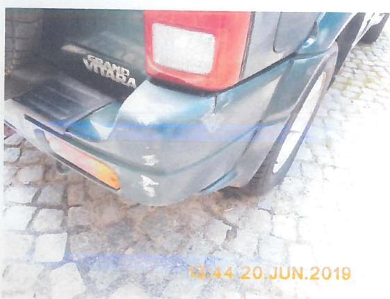
Obr. P5 – Detail poškození zadního nárazníku
