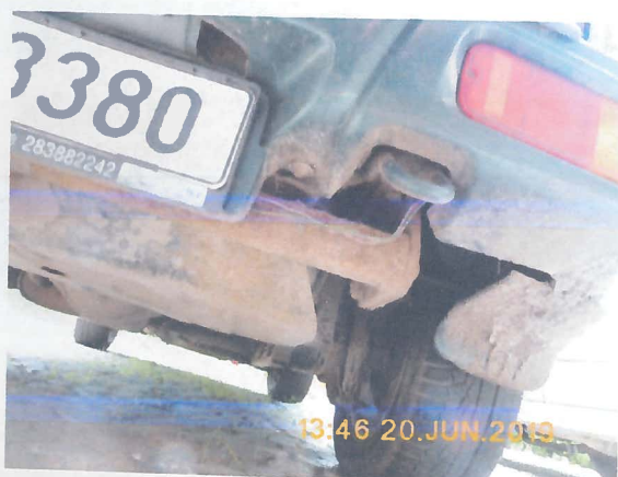
Obr. P11 – Detail koroze spodní části vozidla
