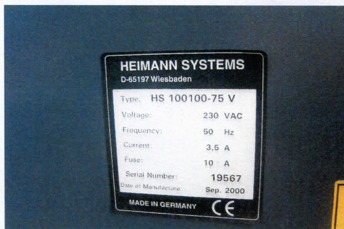
Obr. 5 Výrobní štítek RTG HEIMANN HI-SCAN100100V-75
